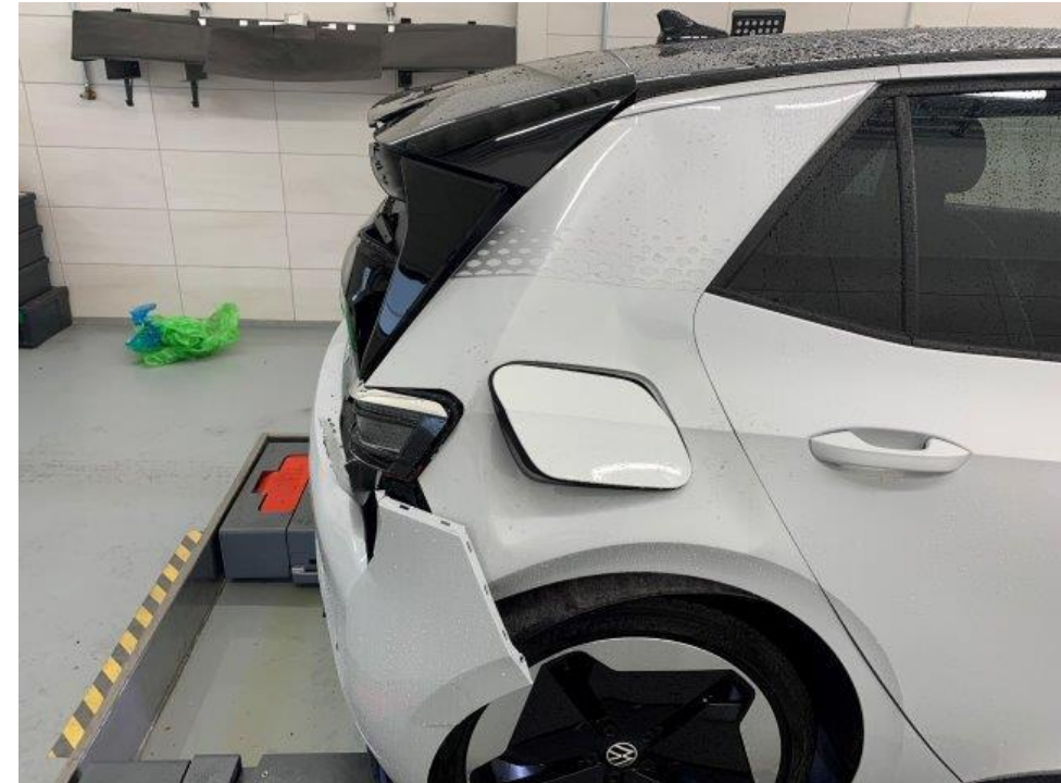
Positivbeispiel: VW ID3 – Reparatur mit Batterie-Erhaltung trotz schweren Heckschadens
